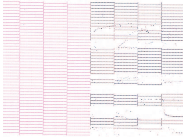
ノズル詰まり
